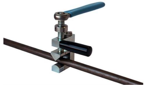
Selon le modèle, le choix du matériau à écraser se fait par l'intermédiaire d'une molette de réglage servant par la même occasion de cale, limitant ainsi l'écrasement selon le type de matériau. Le réglage, simple et rapide, s'effectue en positionnant le marquage indiqué sur la molette, face à l'index se trouvant sur le corps de l'écrase tube.
